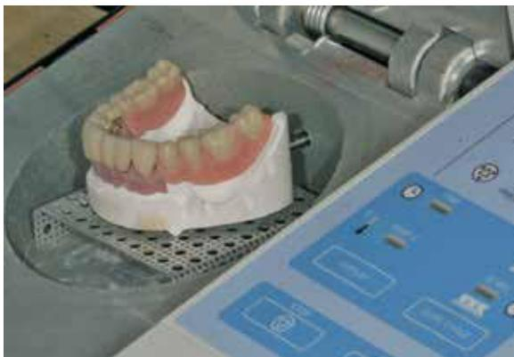
Abb. 126: Endhärtung und Vergütung in der Curing Unit.
