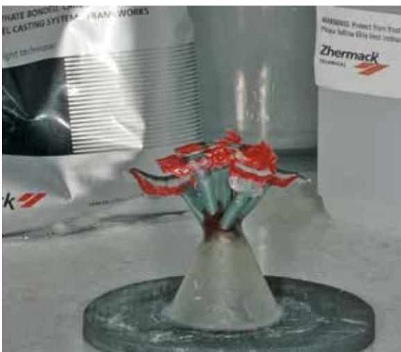
Abb. 72: Einbetten und Gießen im Speed-Verfahren.
